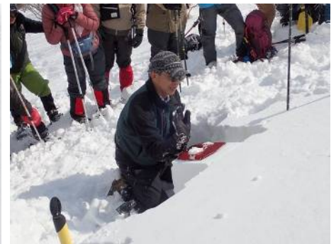
スコップを当てて段階的に叩く(撮影: 浪岡) (手首先、肘先、肩先で)
